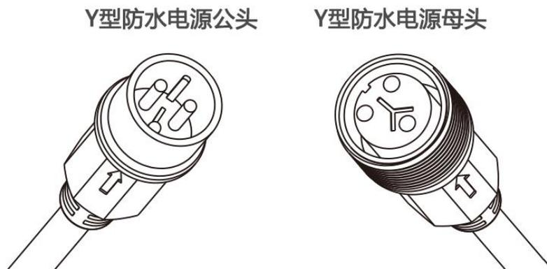
电源线公头与母头必须插紧，以防止因拉扯松动而进水。接头需固定在桁架上，不能掉落地上，以防漏电。如果是手拉手电源，没有用到电源线母头，要用原厂防护盖盖好扭紧。
